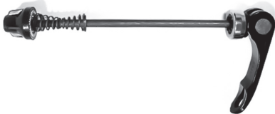
Serrage rapide de moyeu en position FERMÉE (Levier à un angle de 90° par rapport à l'axe du moyeu)
