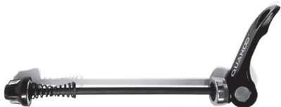
Serrage rapide de moyeu en position OUVÉRTE (Le levier pointe vers le bas).
