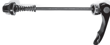
Szybkomocujący napinacz piasty ZAMKNIĘTY (dźwignia pod kątem 90° względem osi piasty)
